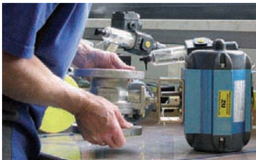
▲ Mühlberger-Mitarbeiter bei der Antriebsmontage.
