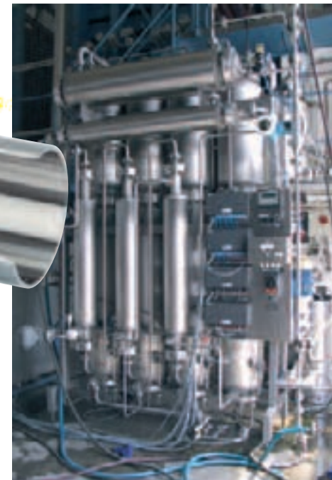
▲ U.a. bei Sanofi-Aventis (Frankfurt) im Einsatz: Mehrstufendruckkolonne „Aqualject“ zur Wasserdestillation mit Connect S
